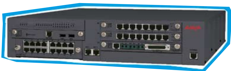
Avaya S8300 Media Server mit einem Avaya G 700 Media Gateway
