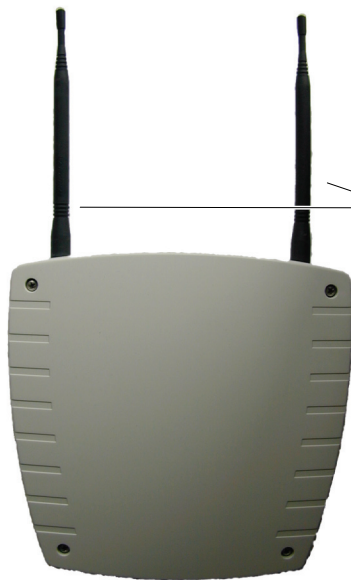
Aufsicht mit montierten Dipolantennen
