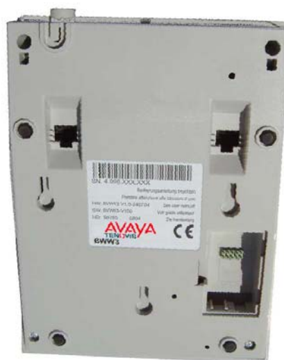
Unterseite BWW3 Buchsen der Ein- und Ausgänge
