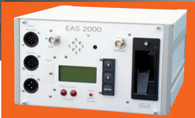
Multifunktionseinheit EAS 2000: Personen-Notsignalzentrale mit Empfänger, Ladeeinrichtung und GSM-Weiterleitung
